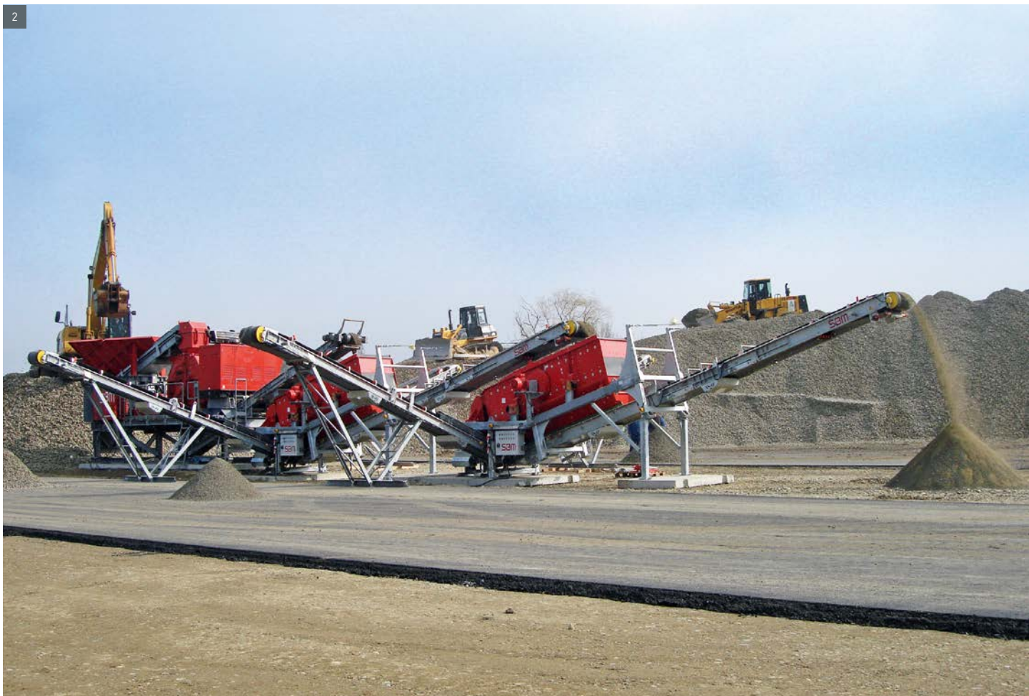
2. SMR 10/5/4 SEMI mit zwei Sieben KQ 15/40-2 SEMI / SMR 10/5/4 SEMI with two screens KQ 15/40-2 SEMI
